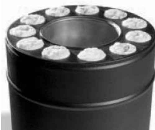
Figur 3: Skorsten Schiedel 6 Steel 60. Skorsten med innerdiameter Ø=150mm och 60 mm isolering. (närmast röret 30 mm aluminiumoxid och utanför detta 30 mm mineralull)
