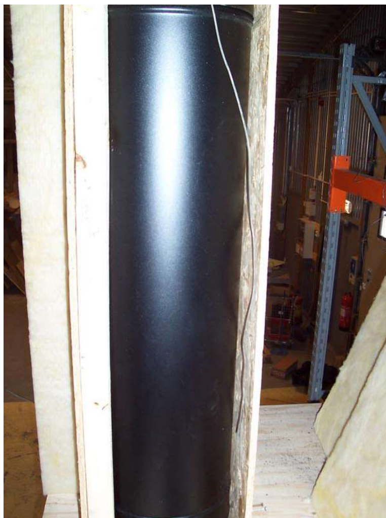
Figur 11. Bilden visar schaktet som omgav skorstenen vid Försök 2 och 3. Avståndet mellan skorsten och skiva är 50 mm..
