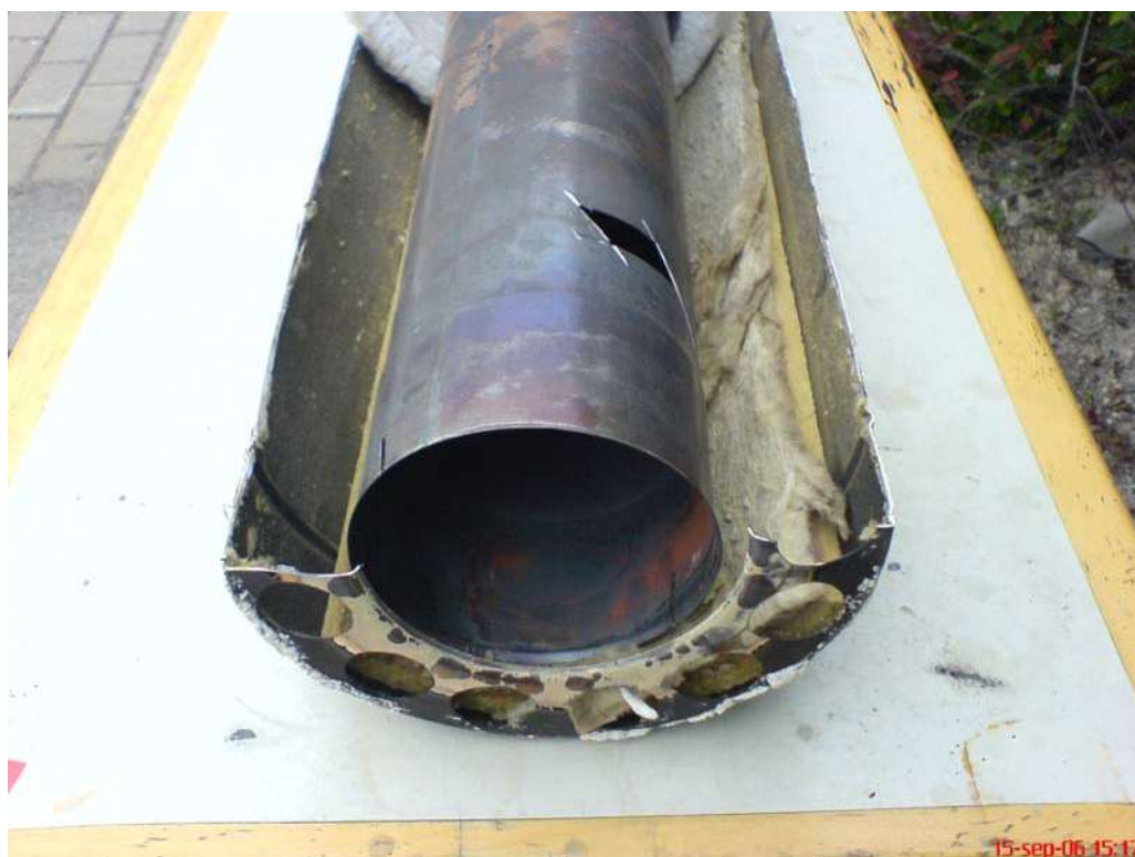
Figur 21 Figur av skorstenen efter 2 förbränningsprov. Man kan se att det finns vissa missfärgningar i stålet men vid en närmare studie visades inga förändringar i materialet. Inte heller isoleringen hade påverkats av den höga skorstenstemperaturen.
