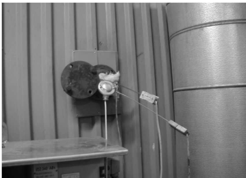
Figur 41 Tre olika termoelement i samma hål (extrahål för urealansar)
