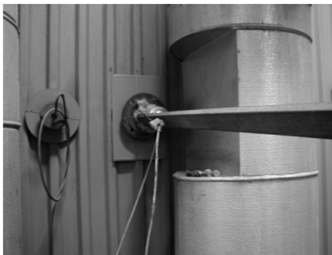
Figur 40 Sugpyrometer och termoelement vid mätning
