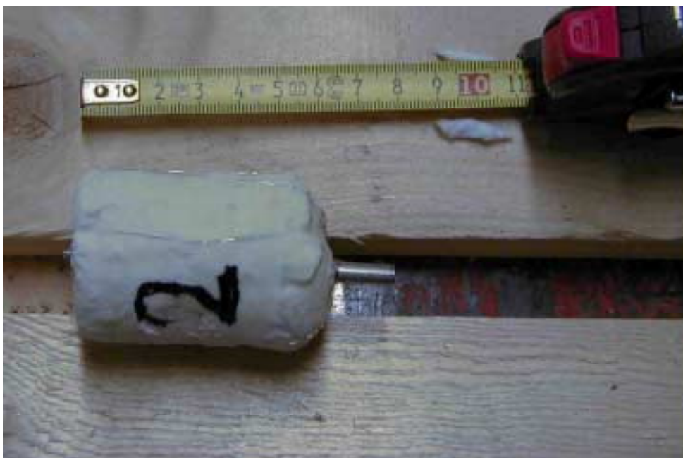
Figur 6: Simulerad bränslepartikel. Kvartsampullen stoppas in i röret till höger; därefter stoppas en liten tuss isolering in i hålet och röret kläms ihop i änden.
