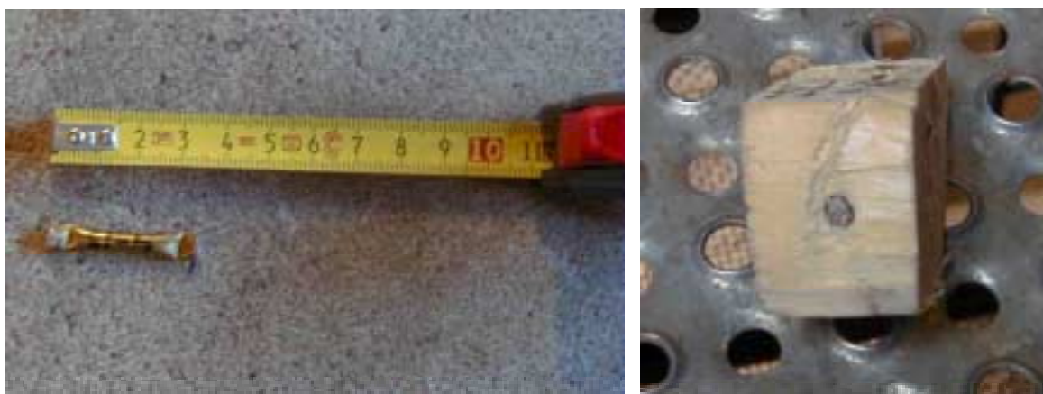
Figur 1: ^{85}\text{Kr} -ampull före och efter insättning i träbit
