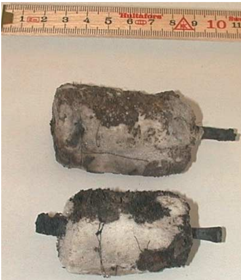
Figur 22: Simulerade bränslepartiklar efter passage genom pannan. Lägg märke till slagget som bränt fast vid partiklarnas yta.
