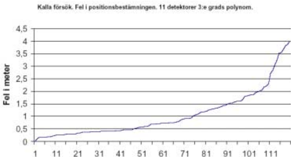
Figur 20: Fel i positionsbestämning med 11 detektorer och ett tredjegradsuttryck för detektorresponser. Felen är sorterade i storleksordning. Mindre än 40 % av positionerna är uppskattade med ett fel mindre än 0,5 m. Ett antal punkter är uppskattade med ett fel som är större än 1,5 m.
