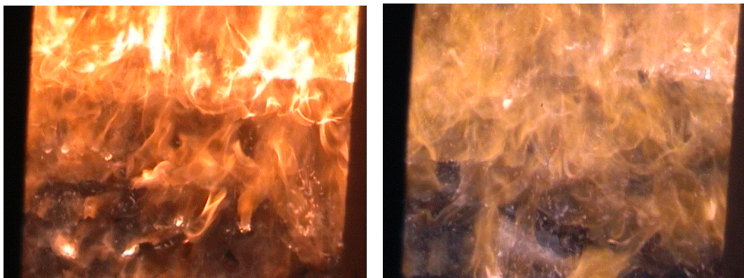
Figur 8. Förbränningsförloppet vid inblandning av 25 % (vänster bild) respektive 10 % papper/plast/trä (höger bild)
