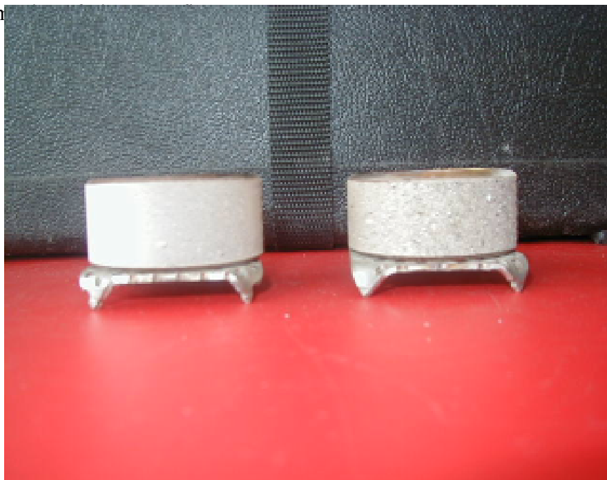
Figur 10. Påslagsringar från referensbränsle(vänster) och blöjor (höger) vid 400 °C.
