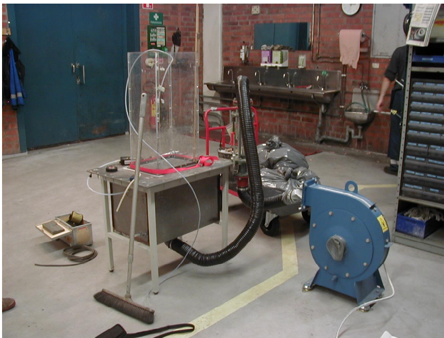
Figur 3. Försöksutrustning för tryckfallsmätningar i bränslet Figure 3 Testing equipment for fuel pressure drop measurements
