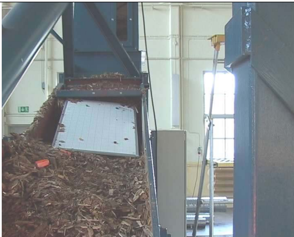
Figur 19 Kalibreringstavla med inlagda olidfärgade magneter
