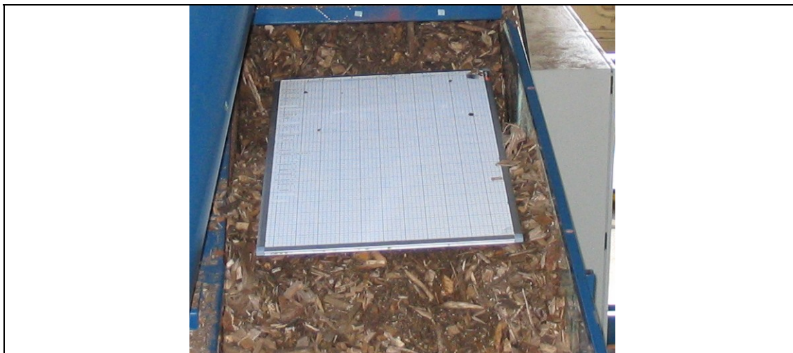
Figur 10. Kalibreringstavla liggande ovanpå bädden vid de kalla försöken. Kalibreringstavlan är en ordinär närvarotavla för kontorsbruk.
