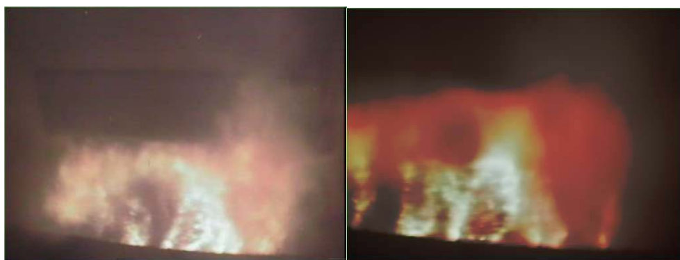
Figur 2 I den högra bilden har signalen medelvärdesbildats under någon minut. Detta gör att stoftp Partiklar filtreras bort samtidigt som stråk i förbränningen blir tydligare.
