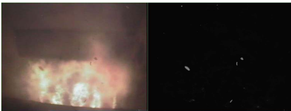
Figur 1 Kontrasten i den vänstra bilden är ändrad och partiklarna framträder och är möjliga att räkna automatiskt.
